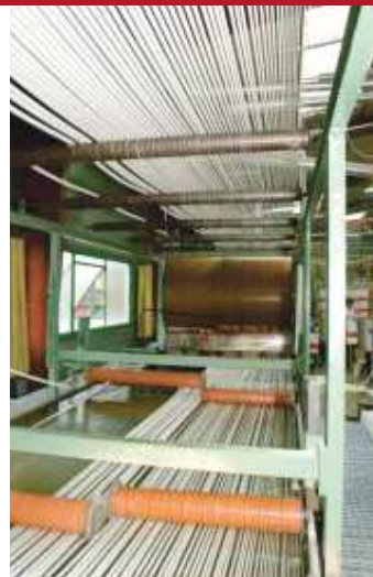
Fabrication de bougies sur fileuse.
